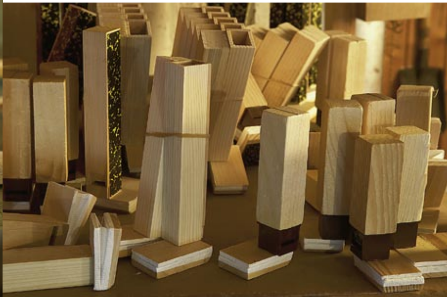
Diese „Orgelpfeifen“ werden in Kuckucksuhren eingebaut. An jeder Pfeife hängt ein Blasebalg, der die Luft für den Ton liefert.
