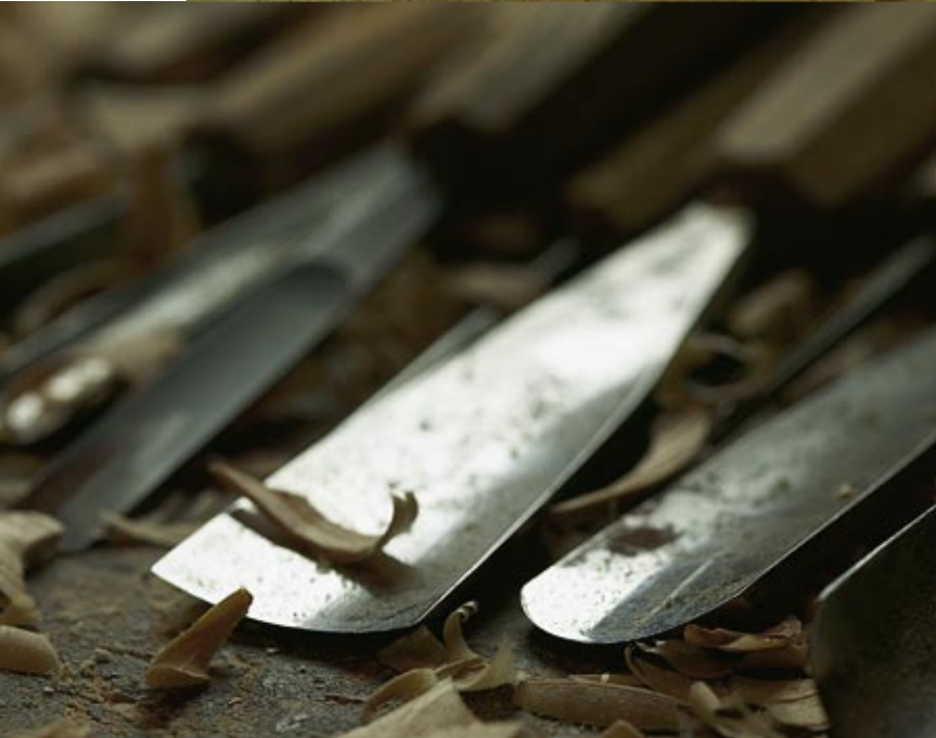
Schnitzsisen in verschiedenen Breiten und mit unterschiedlichen Krümmungen
