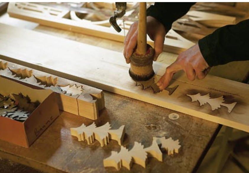
Mit Beize wird der Umriss von Baumschablonen aufs Holz übertragen und dann ausgesägt.
